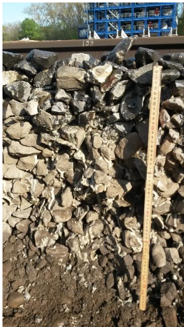
Abb. 2: Präzis dosierte Schotterverklebung, Poren sind offen (wasserdurchlässig), Kleber gelangt bis auf Planie (homogener Schotterkörper)
